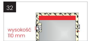
Wzmocnienie pod samozamykacz z blokadą ramienia DORMA wymagane przy zakupie samozamykacza nawierzchniowego nie dotyczy wzorów Perfekt: 8, 8-1, 9, 9A, 9B Glass: 1A, 2B, 3B Glass View: 2B, 3B
