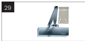
Samozamykacz nawierzchniowy bez blokady ramienia DORMA z elementem mocującym Wymagane wzmocnienie pod samozamykacz kolor: srebrny (1), czarny (2) do drzwi otwieranych na zewnątrz
