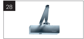
Samozamykacz nawierzchniowy bez blokady ramienia DORMA Wymagane wzmocnienie pod samozamykacz kolor: srebrny (1) czarny (2) do drzwi otwieranych do wewnątrz
