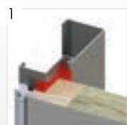
Wypełnienie skrzydła PEŁTA SKALNEJ WEŁNY MINERALNEJ
